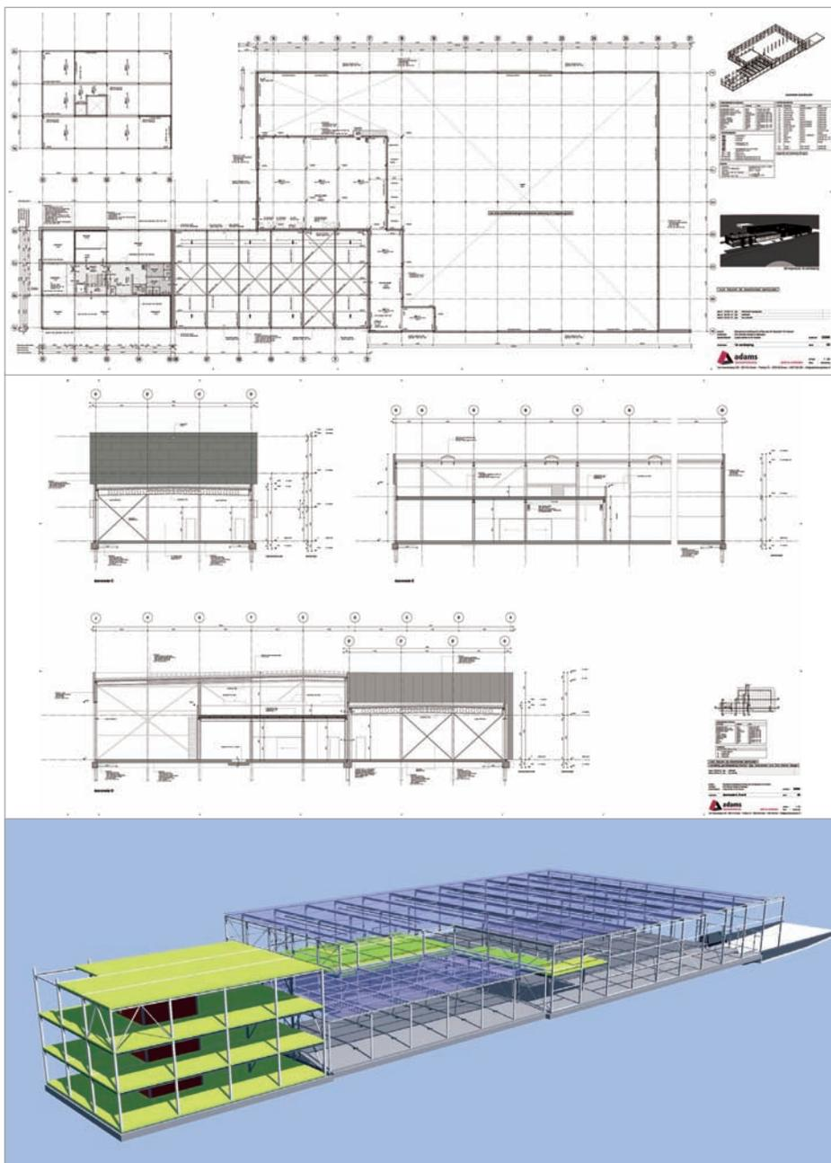
Vijf dimensies en drie disciplines, allemaal gecombineerd in een 3D model: Virtueel Bouwen. Het virtuele gebouw is meer dan een impressie alleen. Het vormt de basis voor tekeningen, calculatie, planning en onderhoud. Door de integrale combinatie van de disciplines ontstaat een efficiënte werkwijze in tijd, afstemming en kosten. Bij de realisatie van dit project hebben we gebruikt gemaakt van het concept Virtueel Bouwen met onze software.
