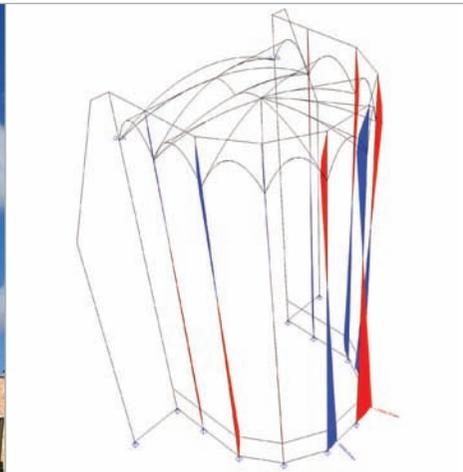
Dans le cadre d'un projet de construction, il a été demandé aux étudiants d'étudier la stabilité du chœur de la collégiale, c'est-à-dire des fondations, des colonnes et des voûtes car des désordres structurels ont été constatés (fissures, chutes de morceaux de stucs, déplacements importants de parties de la charpente ...).
